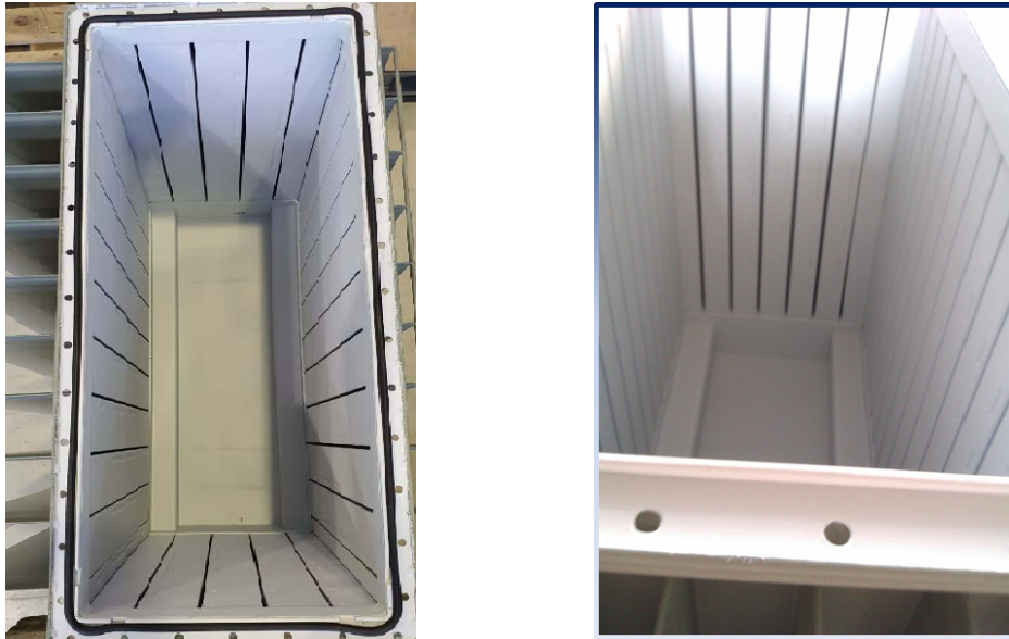
Slika 3. Unutrašnjost kotlova distributivnih transformatora obojani uljootpornim premazom
